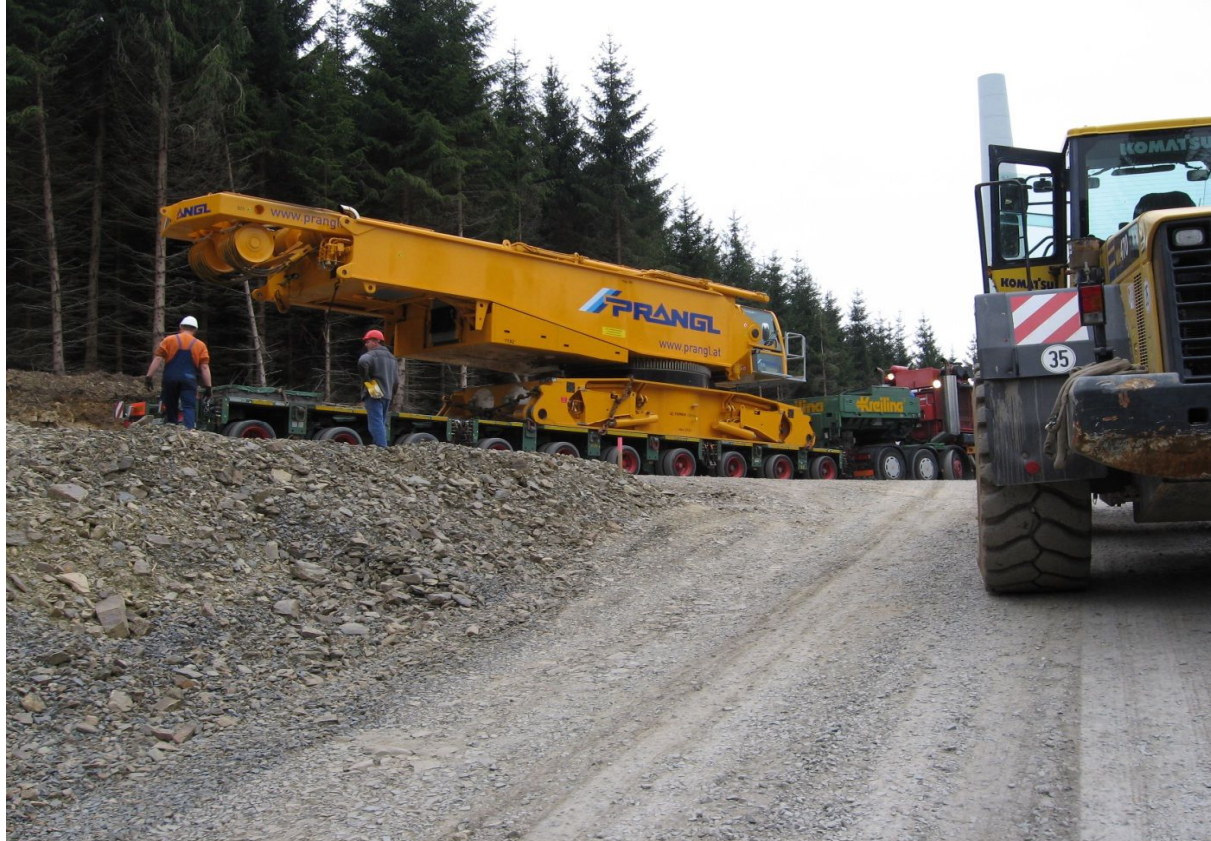
Anlieferung des 800 t - Raupekranes
